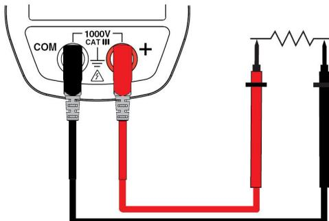
Besteht Durchgang, d.h. der Widerstand ist kleiner als die eingestellte Schwelle (siehe § [3.4.1](#)), ertönt ein Signal und der Messwert erscheint in der Digitalanzeige.
