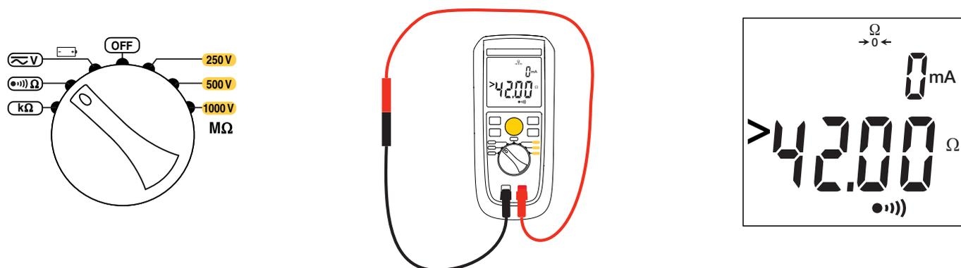
Si el display indica **>42.00Ω**, es que el fusible se ha fundido y necesita ser reemplazado.
