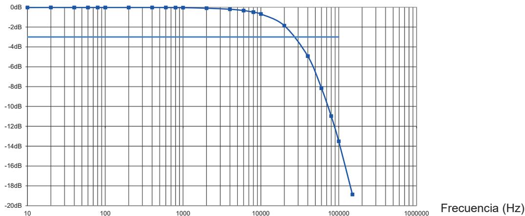
Curva típica del error en amplitud a 100 A en función de la frecuencia, I = 0,5 A, rango 1 V/A
