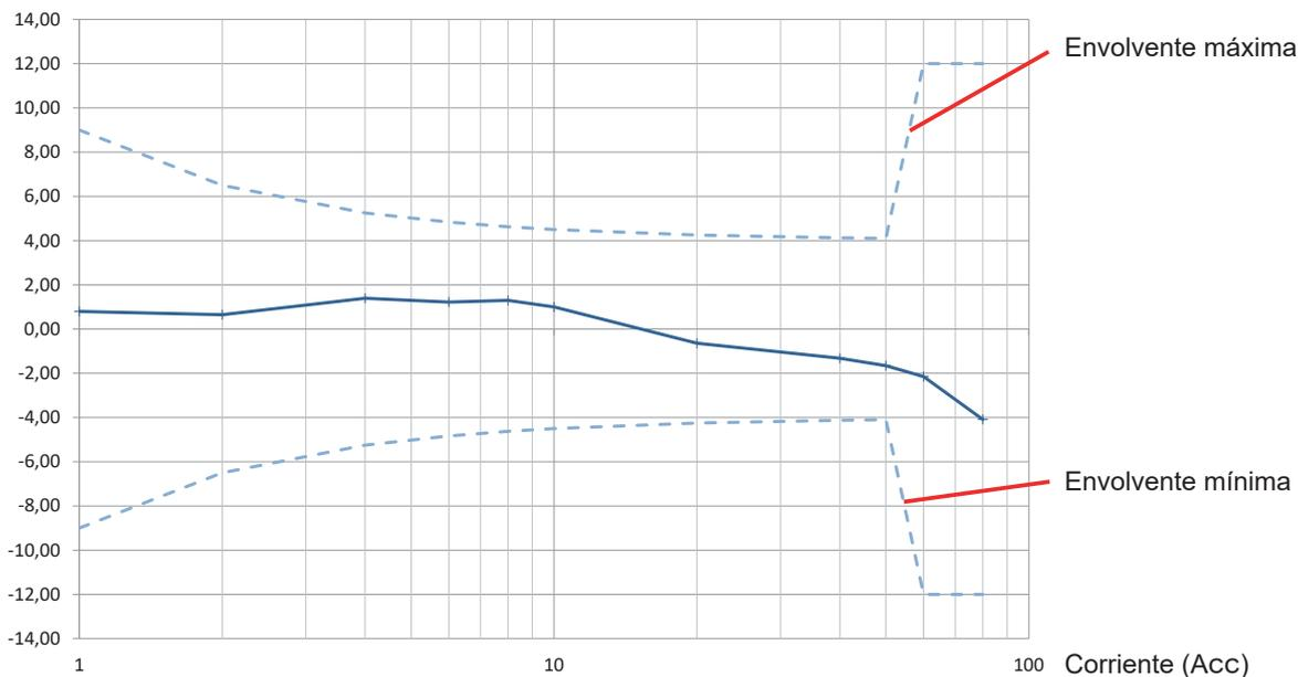
Curva típica del error en amplitud para una corriente CA 60 Hz rango 10 mV/A
