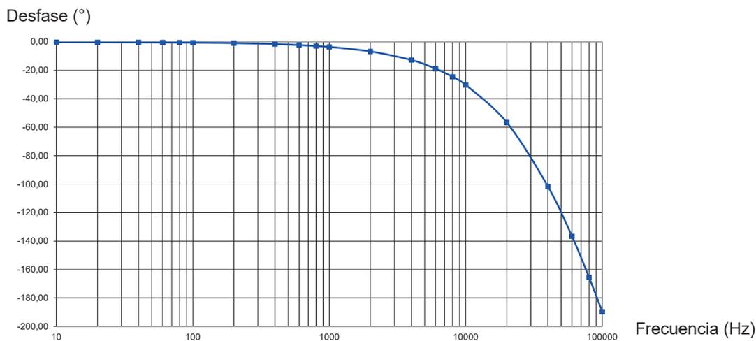
Curva típica del error de fase en función de la frecuencia, I = 0,5 A, rango 1 V/A
