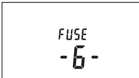
Indica que el fusible de protección del terminal G está defectuoso.
