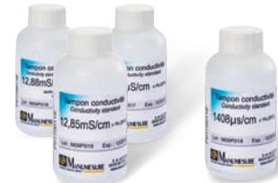
Um zu prüfen, ob die vom Hersteller angegebene Zellkonstante immer noch gültig ist, muss ein Leitfähigkeitsmessgerät vor den Messungen kalibriert werden. Für diese Kalibrierung sind Leitfähigkeitsstandardlösungen notwendig und sie muss unter denselben Bedingungen wie die Messung durchgeführt werden, d.h. bei derselben Temperatur, mit demselben Messbereich, Fließverhalten, Lösungsmittel usw.).
