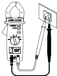
Posicionar el conmutador en V~. Conectar el cordón de prueba rojo en el terminal de entrada "+" y el cordón de prueba negro en el terminal de entrada "COM". Poner a continuación las puntas de prueba tocando los puntos en los que se debe medir la tensión alterna. Leer a continuación el resultado en el display.
