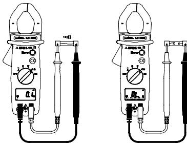
**4.7. Misura di frequenza in tensione
