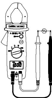
Positionner le commutateur sur "Hz".
