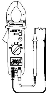
Posizionare il commutatore su  $\Omega$ . Collegare il cavo di test rosso alla boccola d'ingresso "+" e il cavo di test nero alla boccola d'ingresso "COM". Mettere i puntali a contatto dei punti da misurare e leggere il risultato sul display.
