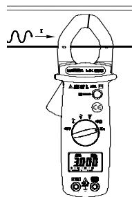
Positionner le commutateur sur "Hz".
