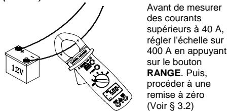
Ouvrir les mâchoires de la pince en pressant sur la gâchette et y insérer le câble à mesurer. Fermer la pince et lire le résultat de la mesure sur l'afficheur.
