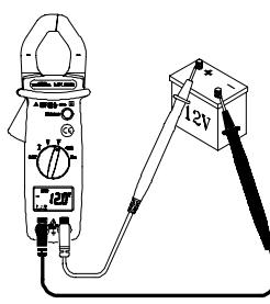
Posicionar el conmutador en V ===. Conectar el cordón de prueba rojo al terminal de entrada "+" y el cordón de prueba negro al terminal de entrada "COM". Poner a continuación las puntas de prueba tocando los puntos en los que se debe medir la tensión alterna. Leer a continuación el resultado en el display.
