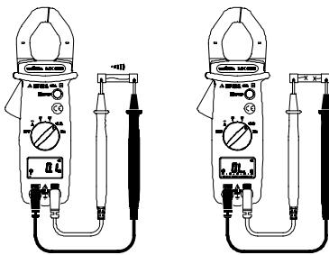
**4.7. Frequenzmessung bei Spannungen
