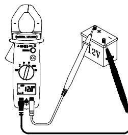
Positionner le commutateur sur V ---. Connectez le cordon de test rouge à la borne d'entrée "+" et le cordon de test noir à la borne d'entrée "COM". Mettre ensuite les pointes de touche en contact avec les points où la tension continue doit être mesurée. Lire ensuite le résultat sur l'afficheur.
