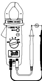
Posizionare il commutatore su "Hz".
