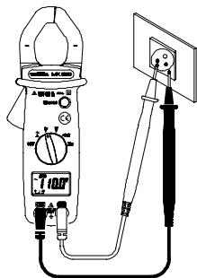
Posizionare il commutatore su V~. Collegare il cavo di test rosso alla boccola d'ingresso "+" e il cavo di test nero alla boccola d'ingresso "COM". Quindi mettere i puntali a contatto dei punti in cui va misurata la tensione alternata. Leggere il risultato sul display.
