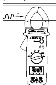
Posizionare il commutatore su "Hz".
