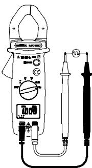
Posicionar el conmutador en "Hz".
