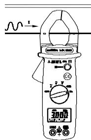
Posicionar el conmutador en "Hz".
