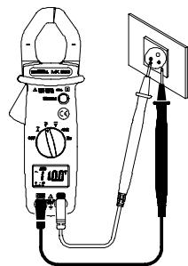
Positionner le commutateur sur V~. Connecter le cordon de test rouge à la borne d'entrée "+" et le cordon de test noir à la borne d'entrée "COM". Mettre ensuite les pointes de touche en contact avec les points où la tension alternative doit être mesurée. Lire ensuite le résultat sur l'afficheur.
