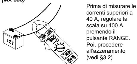
Aprire le ganasce della pinza premendo il grilletto e inserire il cavo da misurare. Leggere il risultato della misura sul display.
