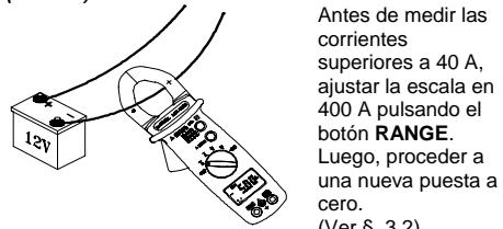
Antes de medir las corrientes superiores a 40 A, ajustar la escala en 400 A pulsando el botón **RANGE**. Luego, proceder a una nueva puesta a cero.
