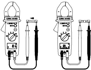
**4.7. Mesure de fréquence en tension
