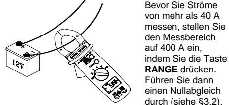
Bevor Sie Ströme von mehr als 40 A messen, stellen Sie den Messbereich auf 400 A ein, indem Sie die Taste **RANGE** drücken. Führen Sie dann einen Nullabgleich durch (siehe §3.2).
