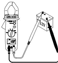
Posizionare il commutatore su V ==. Collegare il cavo di test rosso alla boccola d'ingresso "+" e il cavo di test nero alla boccola d'ingresso "COM". Quindi mettere i puntali a contatto dei punti in cui va misurata la tensione continua. Leggere il risultato sul display.
