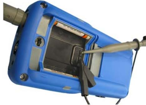
**Connectez la sonde à régler sur la sortie calibration se trouvant derrière cette trappe, comme indiqué ci-contre.**
