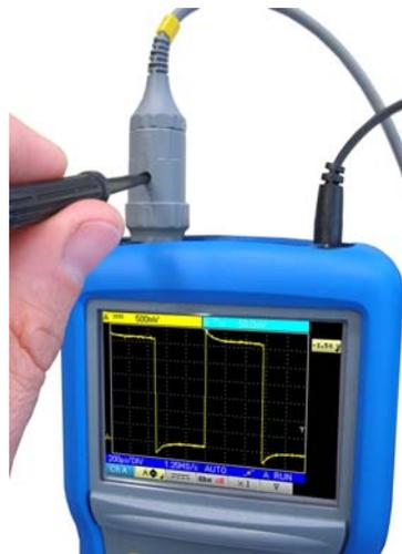
**Dans notre exemple ci-contre, la sonde est sur-compensée : un dépassement apparaît.**
