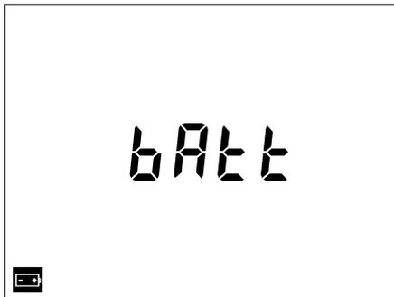
Figure 5 : L'indication de batterie faible nécessitant un remplacement.
