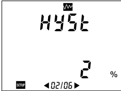
Figure 48 : Affichage du paramètre relatif à l'hystérésis.
