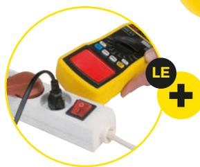
Détection de tension sans contact (NCV)
