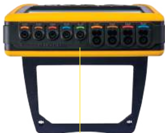
Terminal de medição de entradas isoladas
