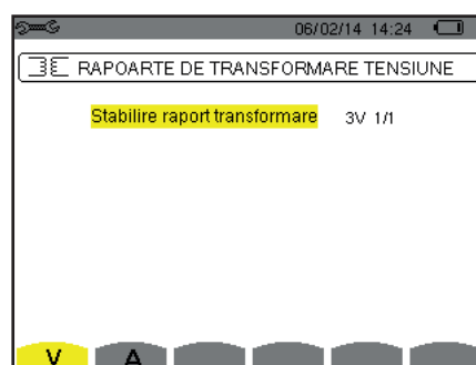
Figura 28 : Ecranul Divizoare de tensiune, din meniul Senzori și divizoare în cazul unui montaj cu nul
