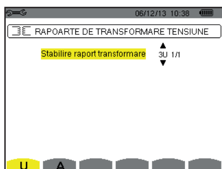
Figura 27 : Ecranul Divizoare de tensiune, din meniul Senzori și divizoare în cazul unui montaj fără nul
