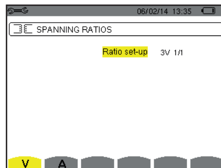
Figuur 28 : Het scherm Spanningsverhoudingen in het menu Sensoren en verhoudingen in geval van een montage met nulleider
