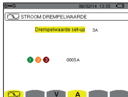
Figuur 30 : Het scherm Stroomdrempels in het menu Transiëntmodus
