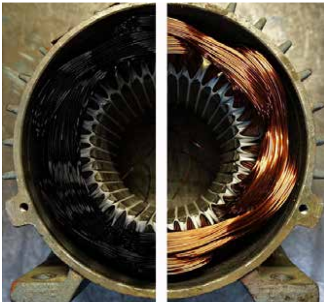
Durch Spannungs-Unsymmetrien verursachte Wicklungsschäden
