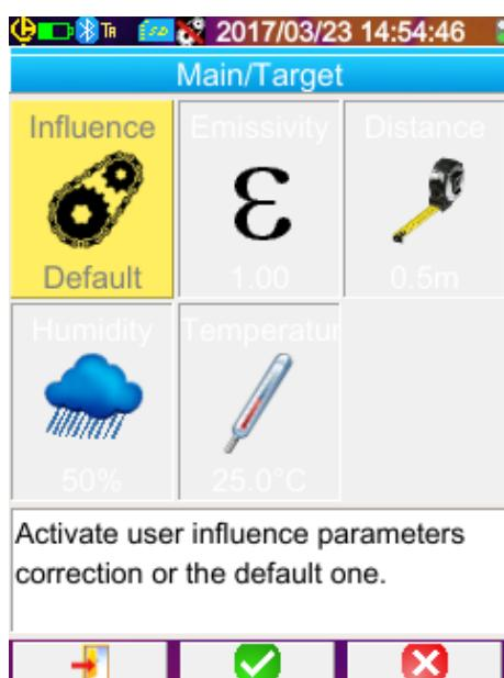
Výchozí kompenzace faktorů ovlivňujících snímání odpovídá kontextu kalibrace kamery (příklad: emisivita má fixní hodnotu 1,00, vzdálenost je 0,5 m, vlhkost činí 50 % a teplota prostředí dosahuje 25° C).
