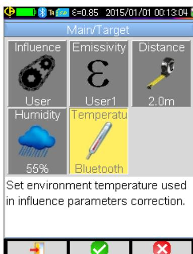
V případě parametrů ovlivňujících měření nahrazují měření údaje, které uživatel zadá v nabídce Hlavní/Cíl, pokud zvolí uživatelské ovlivnění (viz §3.2.2. [Používání kompenzace uživatelských faktorů ovlivňujících snímání](#)).
