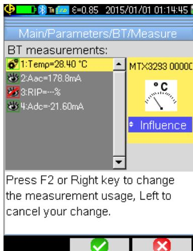
Pro měření uplatněná k **ovlivnění** je nutné přiřadit uplatnění vlivu v okně zobrazení měření přes Bluetooth (nabídka Hlavní/Parametry/Bluetooth/Měření):
