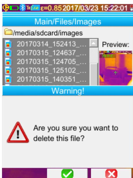
Odstranění snímku se provádí ve správci souborů (nabídka Hlavní/Soubory/Snímky) pomocí tlačítka **F1** .
