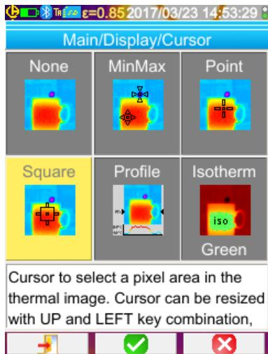
作为默认的设置，没有选择任何测量光标（在菜单主页/显示/光标中选择图标），而摄像机只产生红外线图像。
