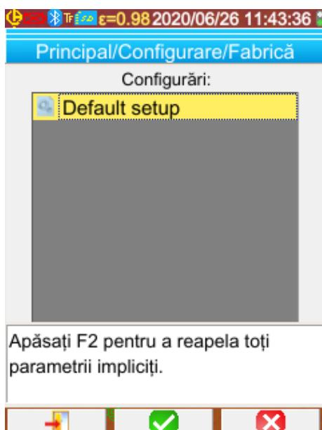
Configurația de livrare face parte din configurațiile predefinite propuse în meniul Principal/Configurare/Uzină.
