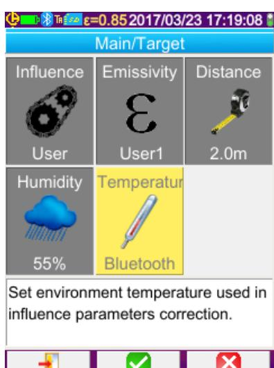
În cazul parametrilor de influență, valorile vor înlocui datele utilizatorului introduse în meniu Principal/Tintă, cu condiția de a fi selectată influență de către utilizator (vezi §3.2.2). [Utilizarea compensării factorilor de influență de către utilizator](#).
