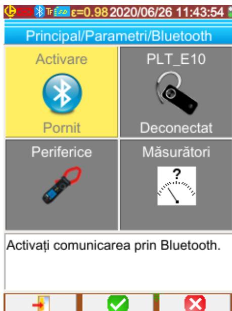
Pentru a utiliza această funcție, trebuie să începeți prin a o activa din meniul Principal/Parametri/Bluetooth, punând elementul Activare pe „Pornit“ (validați elementul cu F2 , pentru a permite introducerea, utilizați tastele Sus/Jos pentru a schimba valoarea și tasta F2 pentru a valida introducerea).
