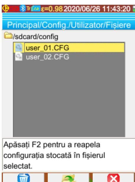
Apelarea unui fișier de configurare se efectuează prin intermediul meniului Principal/Configurare/Utilizator/Fișier, cu ajutorul gestionarului de fișiere care listează toate fișierele de configurare (cu extensia .CFG) aflate în directorul « /media/sdcard/config/ ».
