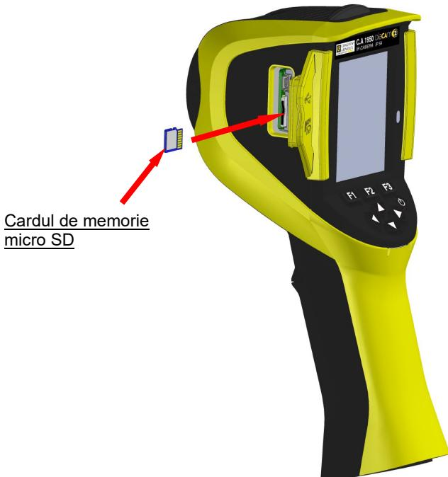
Fisierele create de camera (imagini, fisiere de sunet și de configurație) sunt stocate numai pe cardul de memorie micro SD, care se găsește în partea din stânga a capului.
