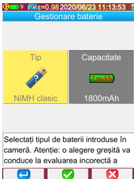
F1 validează diversele elemente introduse și închide fereastra, inițializând sistemul de gestionare a bateriilor cu aceste reglaže.
