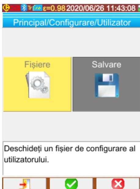
Salvarea este inițiată prin confirmarea cu tasta **F2** a elementului din meniu Principal/Configurare/Utilizator.
