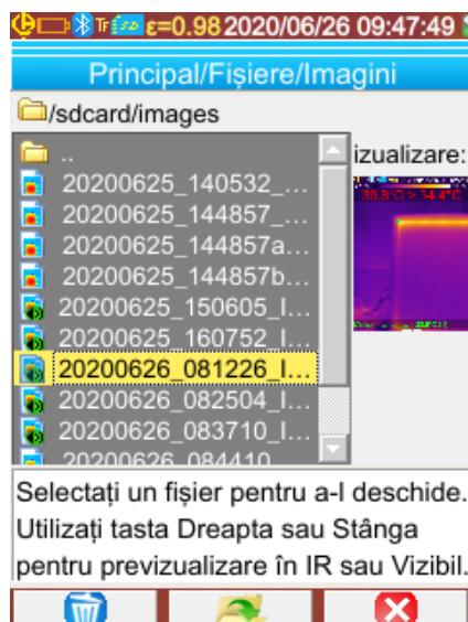
Gestionarul de fișiere nu afișează decât imaginile în infraroșu generate de cameră, cu denumiri precum: aaaallzz\_hhmmssX\_IR.BMP.png, dar și dosarele pentru a permite deplasarea în structura arborescentă a cardului SD.
