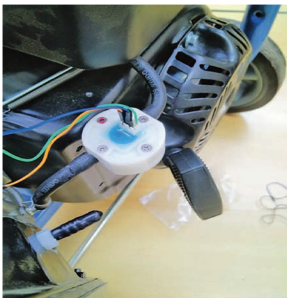
Figure 3 : Débitmètre placé à la sortie du réservoir du moteur thermique
