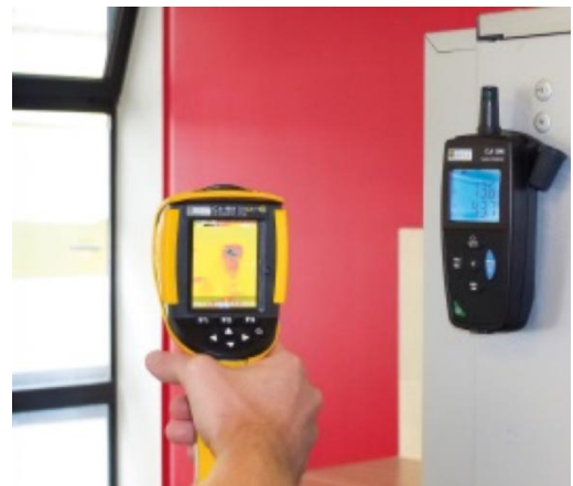
Ex. la caméra C.A 1954 communiquant avec le C.A 1246 (thermo-hygromètre)
