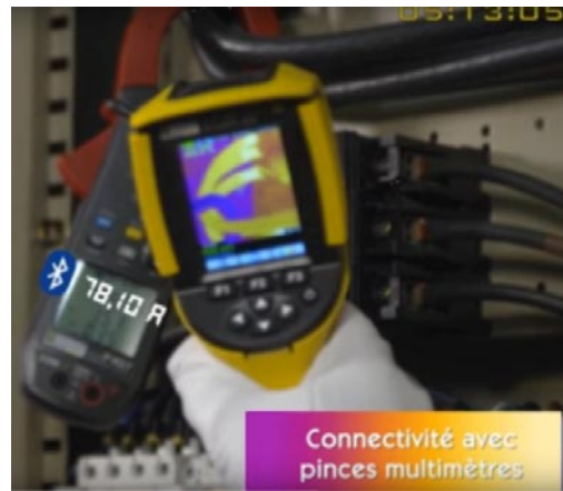
Ex. la caméra C.A 1954 communiquant avec une pince F 407
