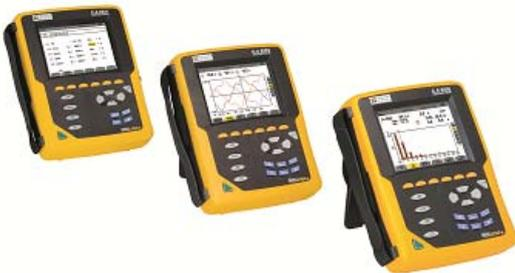
Le mode « harmoniques » permet la représentation sous forme de bargraph des taux d'harmoniques des tensions, courants et puissances jusqu'au 50<sup>ème</sup> rang. Il indique la valeur du THD en %, de la valeur RMS et du déphasage de chaque harmonique. Les courants déformants sont directement calculés pour le dimensionnement des filtres anti-harmoniques.
