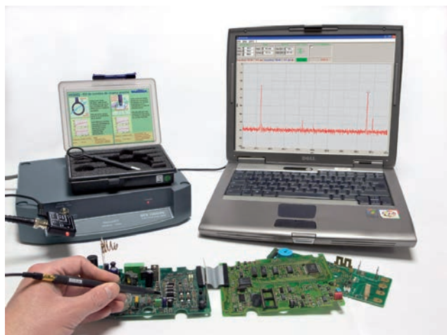
Mesures avec sonde de contact HX0082
