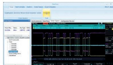
Mit der **EASYWAVE-Software** können im integrierten Signalgenerator arbiträre Signale erzeugt werden, um beispielsweise das Verhalten und die Leistungsfähigkeit von Prototypen mit simulierten Signalen zu testen.
