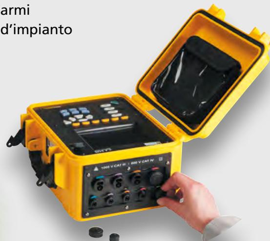
Sono stati ideate coperture degli ingressi specifiche al fine di garantire la massima ermeticità all'analizzatore C.A 8435.
