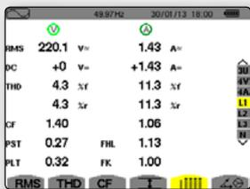
Le correnti armoniche che circolano in una rete provocano un aumento delle perdite negli avvolgimenti. Ne consegue un surriscaldamento del trasformatore e una ridotta longevità degli strumenti collegati.
