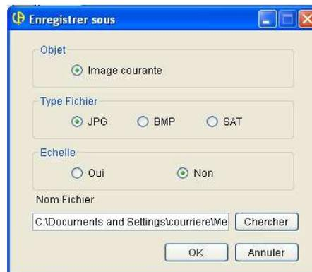
**Note :** Si une image est enregistrée au format JPG avec les données de température, vous pouvez l'ouvrir comme une image thermique et effectuer sur elle une analyse comme vous le feriez avec une image au format SAT.
