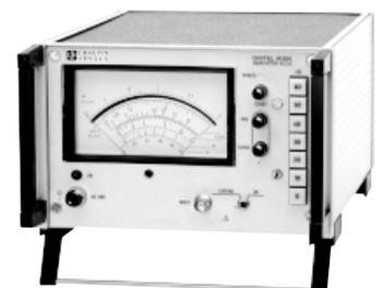
L'appareil est prévu pour être associé à un détecteur quadratique, et le signal hyperfréquence présent à l'entrée du détecteur doit être modulé en amplitude à 1 kHz.
